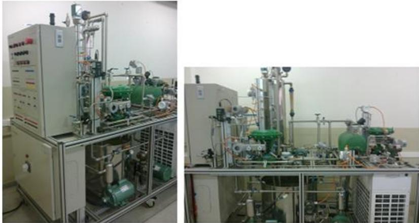
Fig. AIV-3 - Planta didática para estudo de Controle de Processos, Instrumentação e Redes Industriais.
