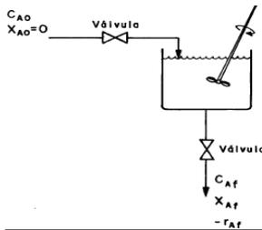
$$(+ \left( \begin{array}{l} \text{Velocidade de consumo} \\ \text{do reagente A dentro} \\ \text{do reator devido} \\ \text{à reação química} \end{array} \right) = (-) \left( \begin{array}{l} \text{Velocidade acúmulo} \\ \text{do reagente A dentro} \\ \text{do reator} \end{array} \right)$$
