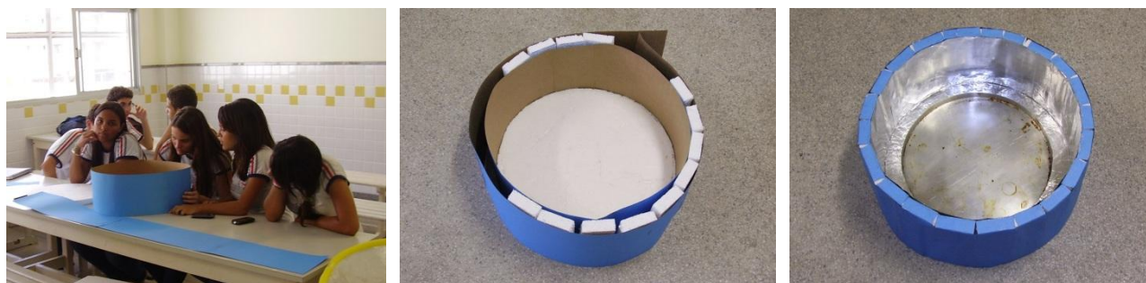
Figura 2 – forno solar em forma de caixa cilíndrica isolada termicamente.
